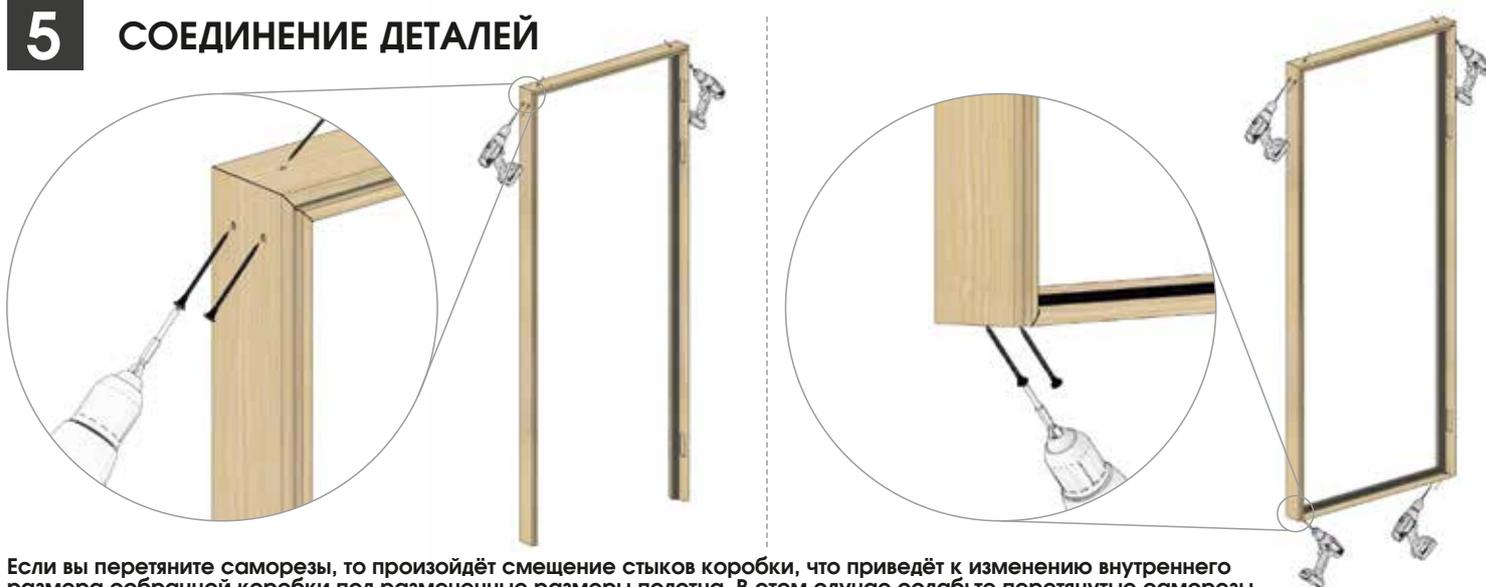
Если вы перетяните саморезы, то произойдёт смещение стыков коробки, что приведёт к изменению внутреннего размера собранной коробки под размеченные размеры полотна. В этом случае ослабьте перетянутые саморезы и повторите их закручивание.
