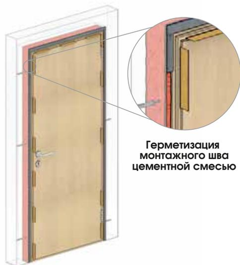
Герметизация монтажного шва цементной смесью
